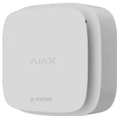
Detektoren har to temperaturfølere som reagerer på økt temperatur. Om temperaturen i rommet går over 64°C eller økes med mer enn 10°C i løpet av ett minutt vil detektoren gå i alarm basert på den raske temperaturstigningen.
